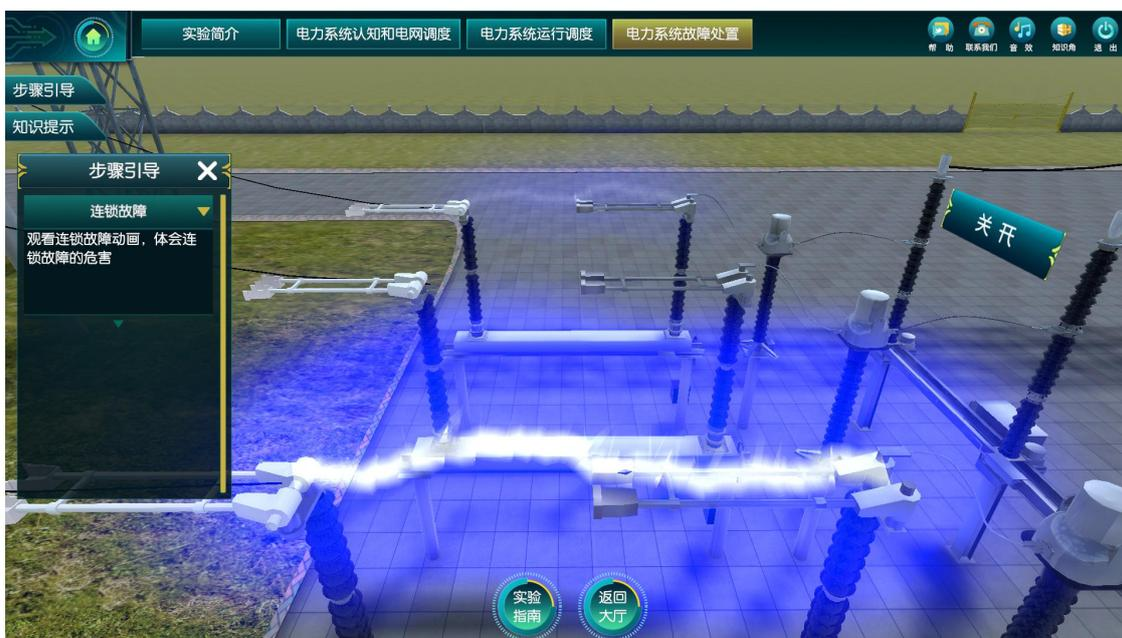
图 35 变电站内断路器跳闸动画
