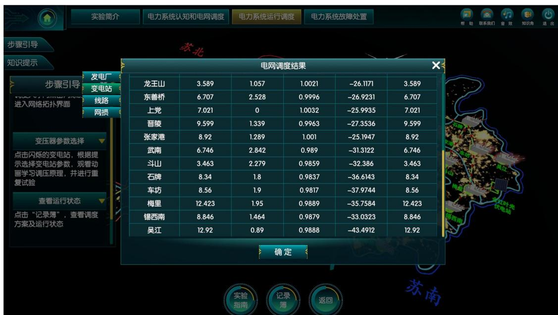
图 28 电压调整后系统运行参数
